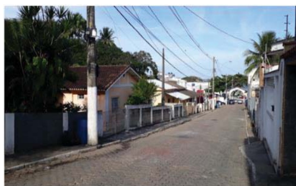
Calçadas estreitas, sem rebaixamento de rampas, e desniveladas
